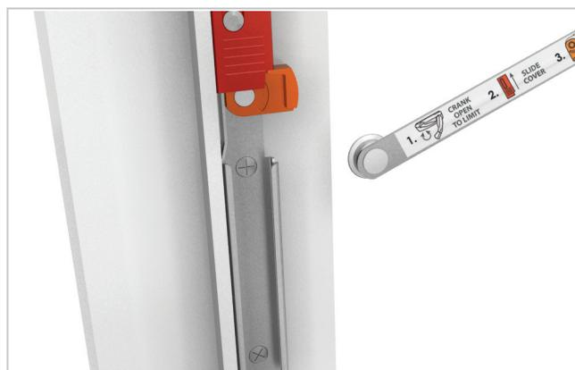
4. Continuez d'ouvrir la fenêtre avec la manivelle tout en maintenant la languette orange en place, jusqu'à ce que la fenêtre soit complètement ouverte.
