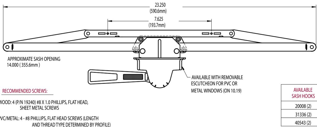
**FIG. 4 SINGLE PULL LEVER OPERATOR 10.14 (removable escutcheon 10.17)**
