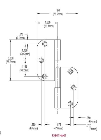
RECOMMENDED SCREWS: 6 (P/N 19250) #8 X 1.0 PHILLIPS, FLAT HEAD, STAINLESS STEEL SHEET METAL SCREWS PER HINGE
